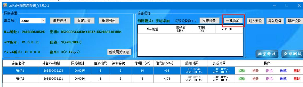
6. 设备列表导入, 导出 (换新网关时, 新网关的密钥、信道、速率必须和旧网关一致, 然后导入旧网关保存的节点列表, 新网关和设备节点不需要再次配对即可进行通信)
